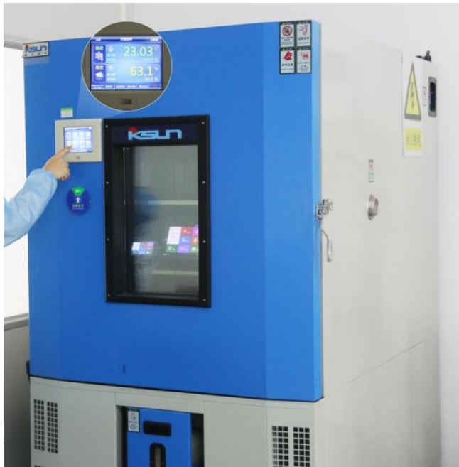
图 5-3 高低温老化测试图
